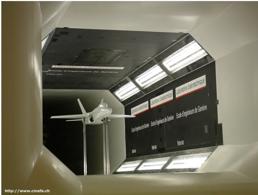
Fig. 7.7 – Essai aérodynamique d'un avion à réaction
