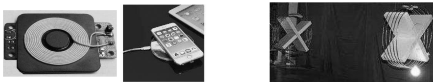
Fig. 1.2 – À gauche : couplage inductif non résonant en champ proche ; à droite : couplage inductif résonant en champ proche
