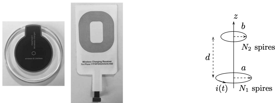
Fig. 1.4 – À gauche : système de transmission classique (émetteur et récepteur) utilisé dans les chargeurs sans fil actuels. À droite : schéma et notations utilisées
