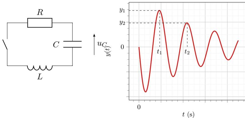
1. Déterminer les valeurs de  $i$ , de  $u_C$  et de  $u_L$  à la fermeture du circuit en  $t = 0^+$ , puis en régime permanent pour  $t \rightarrow +\infty$ .
