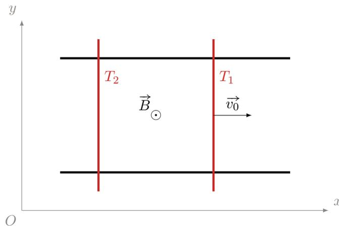
Un champ magnétique  $\vec{B} = B\vec{u}_z$ , permanent, uniforme et vertical, règne en tout point de l'espace. À l'instant initial, on communique à la tige  $T_1$  une vitesse  $\vec{v}_0 = v_0\vec{u}_x$  tandis que  $T_2$  est immobile. On néglige les effets dus au champ propre.
