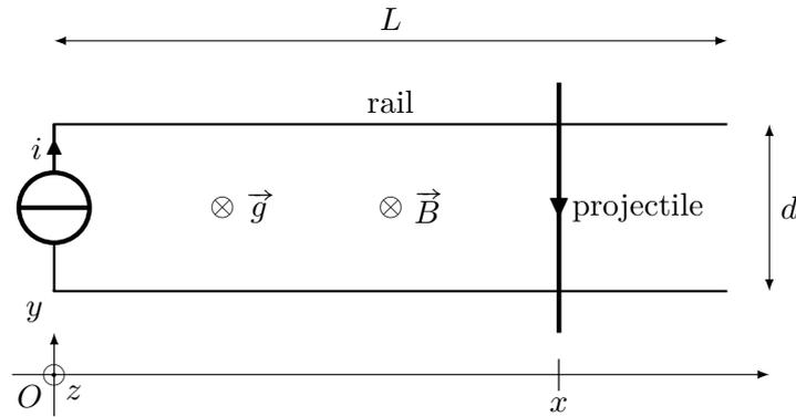
Le projectile est une tige conductrice en liaison glissière avec des rails conducteurs parallèles de longueur  $L$  et distants de  $d$ , placée initialement à l'origine du repère avec une vitesse nulle. Un générateur de courant impose dans le circuit ainsi formé un courant d'intensité  $I$ . Le dispositif baigne dans un champ magnétique  $\vec{B} = -B\vec{u}_z$  que l'on suppose uniforme. La masse du projectile est notée  $m$ .
