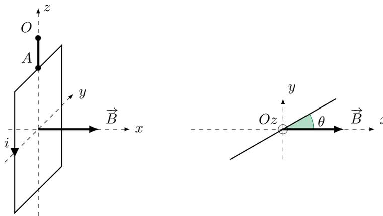
À l'instant initial, aucun courant ne circule dans la bobine, et elle est en équilibre dans le plan contenant le champ magnétique. On y établit alors un courant d'intensité  $I$  constante comme représenté sur le schéma. La bobine se met en mouvement puis finit par s'immobiliser dans une nouvelle position d'équilibre  $\theta_{\text{eq}}$ . Pour simplifier, on négligera les phénomènes d'induction.
