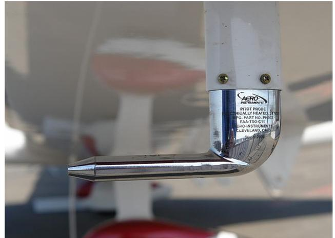
Fig. 6.8 – Tube de PITOT monté sur une aile d'avion
